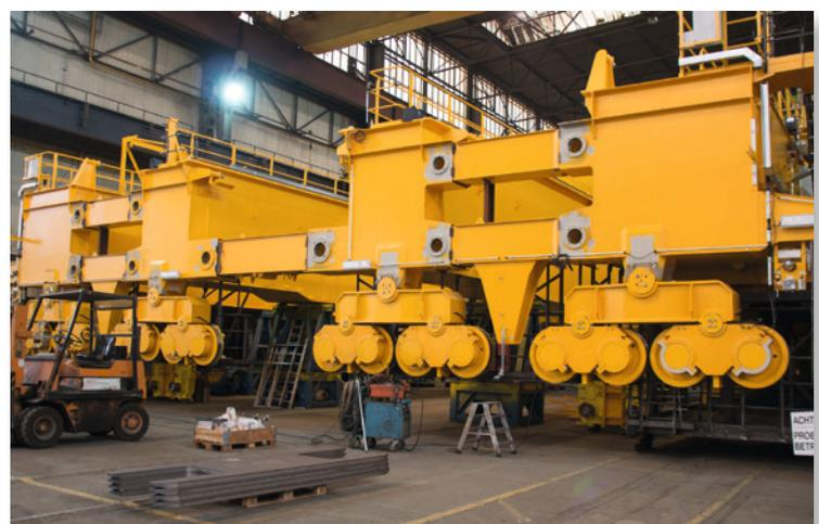
Betriebsmontage Prozesskran (480 t) in der Fertigung von Kranbau Köthen
