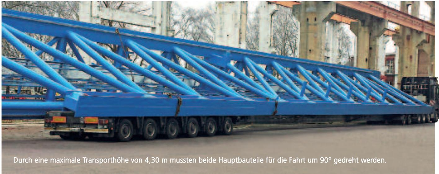
Durch eine maximale Transporthöhe von 4,30 m mussten beide Hauptbauteile für die Fahrt um 90° gedreht werden.
